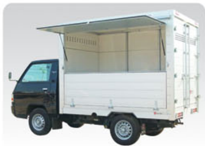
Box Pintu Samping Hidrolis
